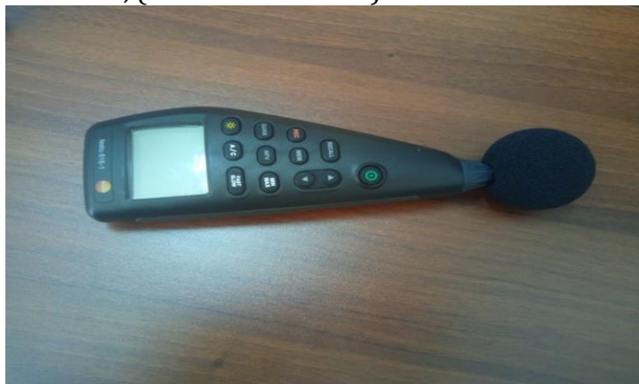
Foto 7. Aparati tip Testo 816-1, (AKM. A. Guri 2019)
