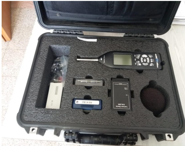
Foto 10. Aparati “Sonometer tip Larson Davis 831” së bashku me kalibratorin, (ISHP. A. Ago 2019)
